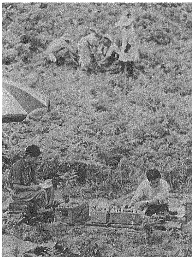
比抵抗法(直流による)の野外測定の例 器械は地質調査所で試作したもの
