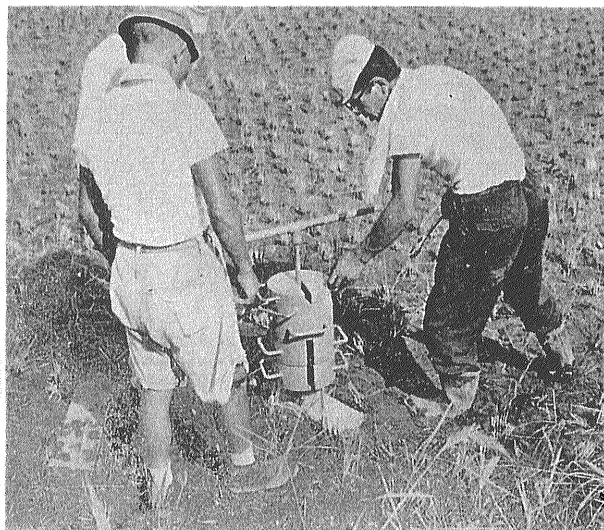
→ (9) スウェーデン式サウンディング 広域にわたって 地盤の強度を測定するため 深度15mまで20cm毎 にその地耐力を測定する 一地域大体20-30カ所の測 定を実施する そして水平および垂直の強度分布図を 作成し 地層の細分を試み 地質状況との比較対照を 実施する
