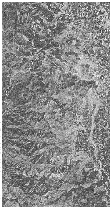
第40図 長野県池田町付近姫川沿岸 西方の山地と東方の山地とは 極めて対称的な侵蝕地形の差が認められる。前者は主として花崗岩 (Gr) によって構成せられ 乳川の湾曲部に二疊紀の堆積物 (p) が小範囲に分布する。後者は新第三紀の安山岩からなる 西側の山脚部 河川の出口には見事な扇状地 (f 1,2 ) が 東側の山脚部には断続的に河岸段丘 (tr) が発達する。扇状地はその扇形の形態 頂部から放射状に発出する分流水系模様から 河岸段丘面は比較的明るい階調を示すこと、卓状をなす形態から それぞれ識別することができる。前者は主として果樹園として利用され 後者は居住地となっている。沖積地 (Al) は水田の示す土地利用の様相から容易にその範囲を知ることができ 現河床はもっとも明るい階調を示すこと、網状水系模様特徴的である
