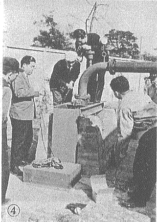
→ ④ 井戸水位の測定 ⑤ 帯水層試験のため揚水して 水位の降下速度を測定する ⑥ さく井の揚水試験
