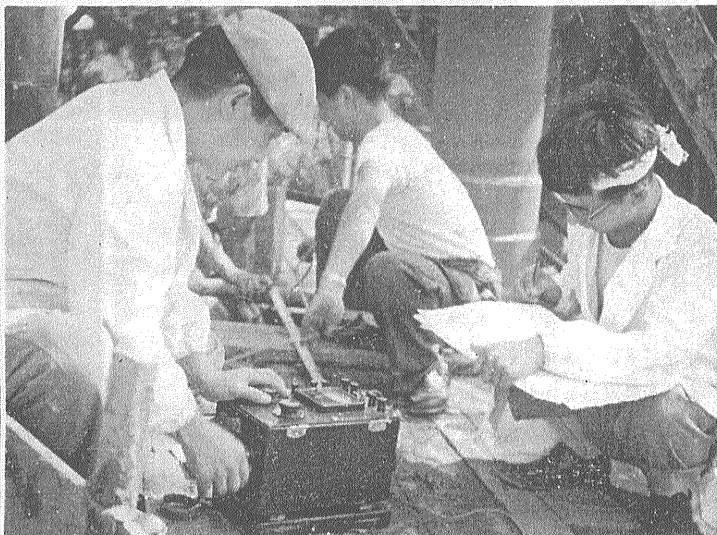
さく井孔内の電気検層
