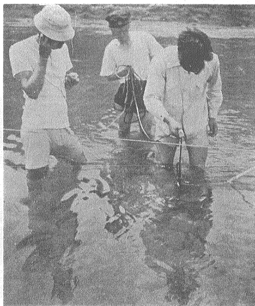
徒渉による流量測定
