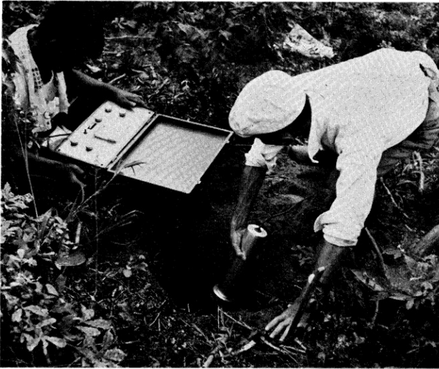
携帯用シンチレーション・カウンターによる放射能探査
