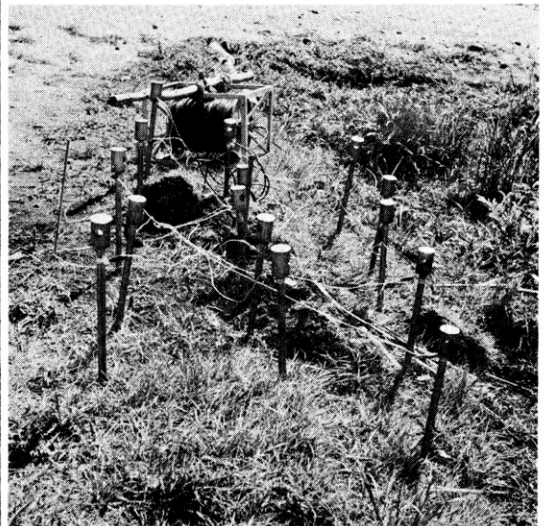
電気探査の電流電極
