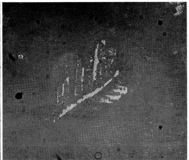
第10図 人工ダイヤモンドの樹枝状結晶の干渉写真
