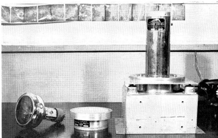
エア・ボーンおよびカー・ボーン探査に使用されているシンチレーションヘッドとその内部にあるクリスタル (直径 5'' 厚さ 2'') と光電子増倍管
