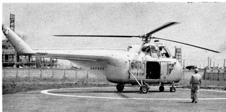
空中磁気探査に使用しているシコルスキー S-25 探査の場合は正副操縦者のほか3名の調査員が搭乗する
