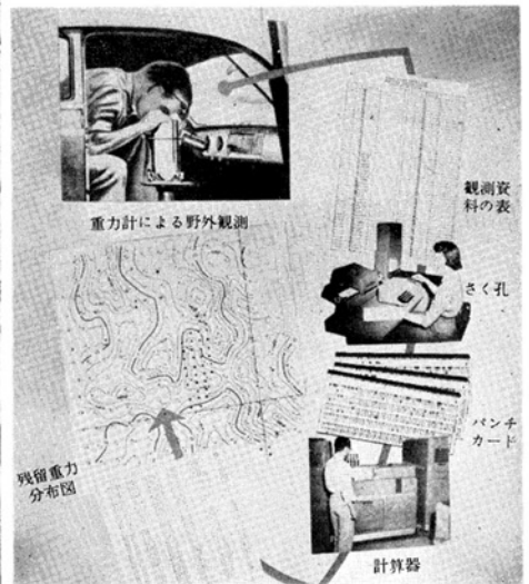
電子計算機によって重力の解析計算が速に行われる 重力のフィールドデータをカードにパンチして 電子計算機にかける と解析結果が印刷されてでてる これを図表にして地下構造との対比に使う
