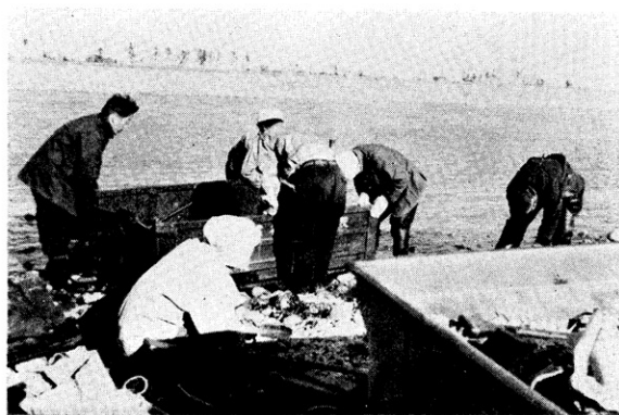
測定地点で舟をおろし組立てる 組立・分解に要する時間は約10分間である
