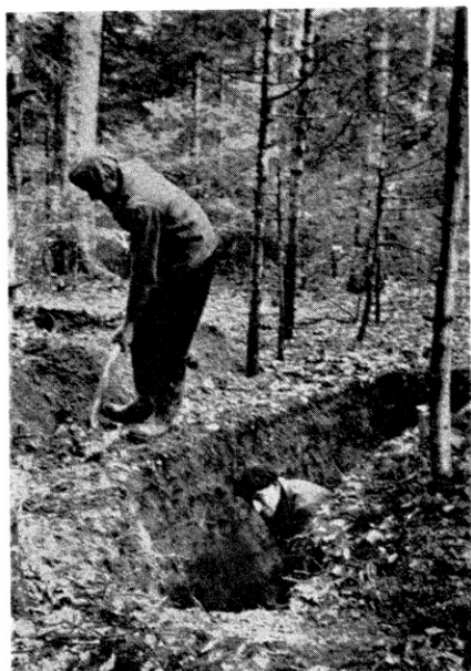
剥土による探鉱
