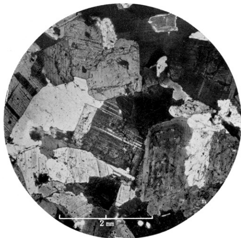
写真①A 花崗岩の顕微鏡写真(木曾駒花崗岩) 白色・石英 細い縞模様・長石(斜長石) 暗色・黒雲母と角閃石 実際には黒雲母は茶色 角閃石は緑色に見える
