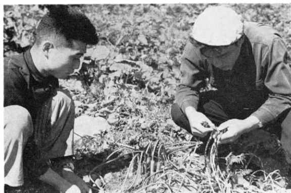
火山地帯では 火薬爆発によって生じた地震波エネルギーが土壌に吸収されるため 各測点でたくさんの受振器を同時に使用する群設置方法を用いるがこれはその方法である
