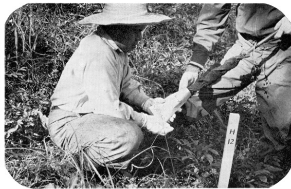
ハンドオーガー(簡易試錐機)で60~100cm下部の土壌を採取する
