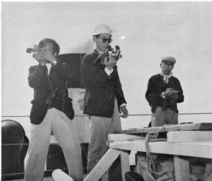
予定地点に到着すると停船し 六分儀を用いて船の正確な位置を測定する
