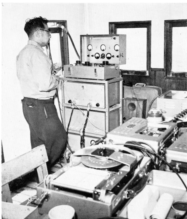
船内に設置された遠隔測定装置(後方)で測定を始める (手前は音響測深器)
