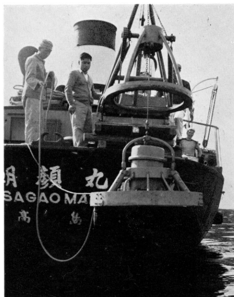
観測地点に到着すると直ちに重力計を海底へ降ろす
