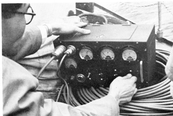
撮影・フィルムの巻き上げはこの遠隔操作装置で行われる
