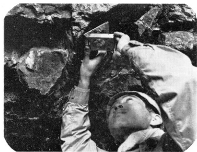
坑内での走向・傾斜の測定 改良型沢田式万能クリノメーターは天盤における測定にその真価を発揮する
