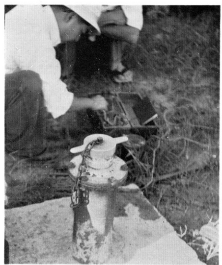
水位観測井 普通水位観測井では 井戸の水位を5日ごとに測定することになっていて 測定には「浮子測定器」「マグネット・ベル」などが使用される 観測井が屋外にあきるときは 写真のようにふたをしカギをかけておく必要がある
