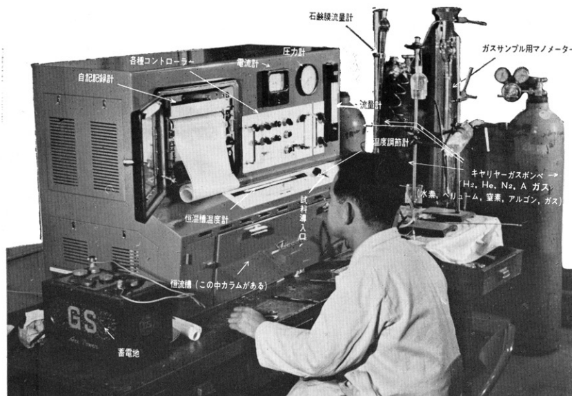
運転中のガスクロマトグラフィー分析装置
