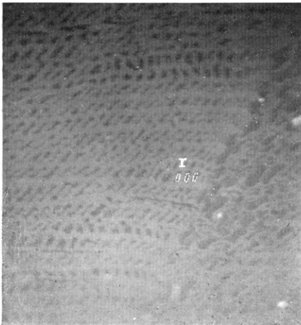
テリニット 最上 ×150 油浸 (r)…細胞腔をみたしている レジニット ビトリニットのうちで細胞組織がみとめられるものをテリニット(tel.)と呼びほとんど細胞組織がみとめられないものをコリニット(col.)とよぶ
