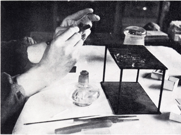
⑧ カバーガラスの縁のバルサムを除去する
