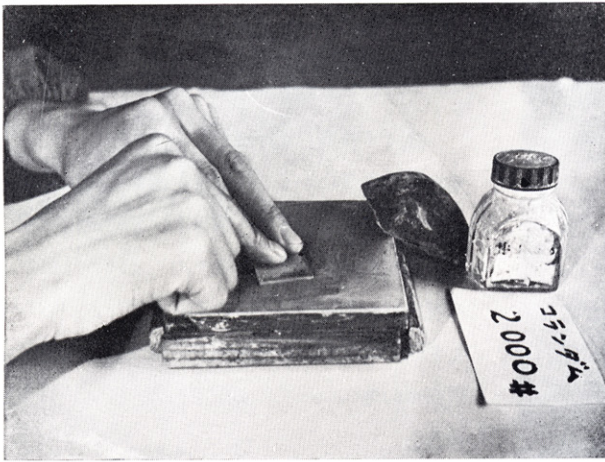
⑥ スライドガラスへハリ付けたサンプルはさらに前回同様カーボランダム 180 番 320 番でナリ 最後にコランダム 2,000 番で仕上げる
