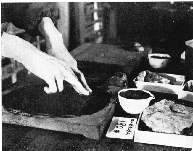
② 砕いたサンプルをカーボランダム180番で荒ざりする
