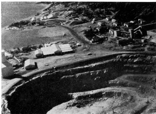
Beaverlodge 地区 Gunnar 鉱山 露天掘と堅坑が見える 湖は Lake Athabasca で 露天掘の底は湖面以下 50m くらいであるが 水の湧出は全くない
