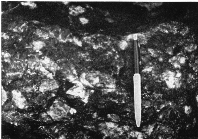
Blind River 地区の鉱石 白い部分は石英質の小礫で 黒い 部分は主として黄鉄鉱からなる Matrix である
