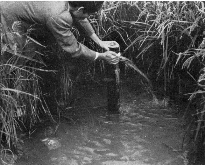
水と一緒にガス気泡が自噴している （宮崎市曾崎 宮崎県試掘第1号井）
