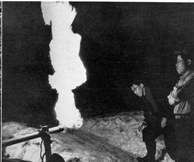
焰長法によるガス量の測定 （北海道長万部 試掘1号井）
