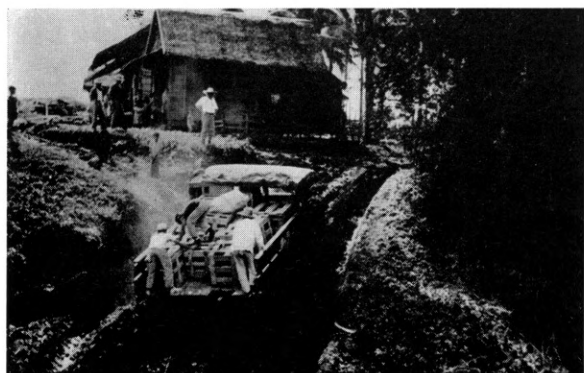
急峻な悪路を特殊トラックで調査荷物の運搬(ウインチで巻上げている)
