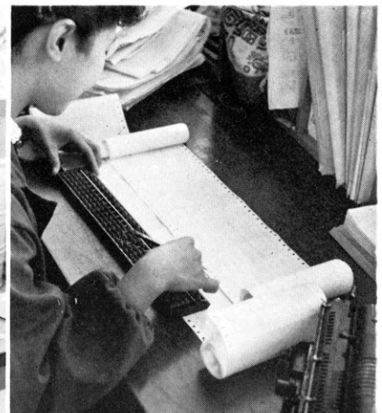
放射能強度と対地高度の記録を対照して 一定高度における放射能強度を約380m毎に 次々に計算していく（記録紙の全市6吋 長さ103フット）
