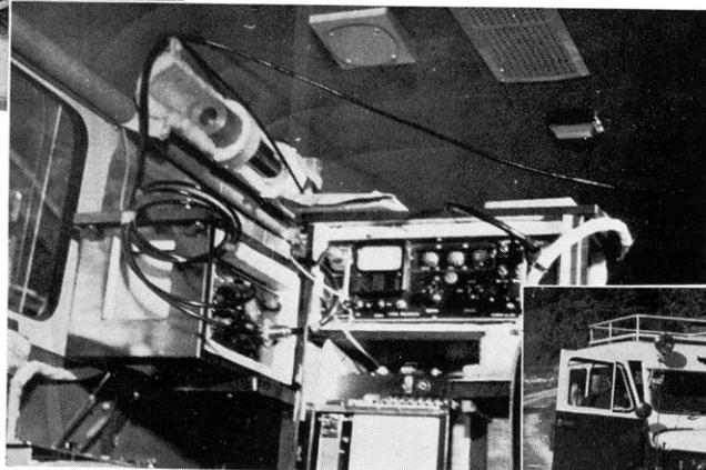
車内に取りつけたシンチレーション・カウンター(科学研究所製)操作員の席の周囲にミキサースケイラー・レコーダー・電源がならび天井にインターホン用スピーカーや換気孔がまた天井の両側には各1個ずつのヘッドがついている
