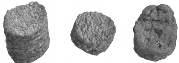
これは地すべり地の岩盤のボーリングコアである 一見堅いと見える黒色泥岩も 水中に入れるとこんな姿になつて短時間で糊状の泥となる
