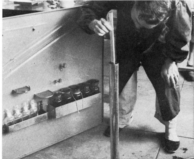
泥水の比重を「ハイドロメーター」で測定する
