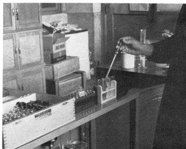
脱水した水の pH を測定する
