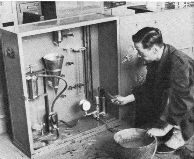
『ウォールビルディングテスター』に手動水圧ポンプで圧力をかけ壁厚と脱水量を調べる
