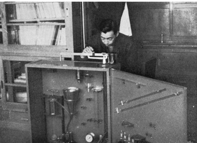
泥水の粘度を『マーシュファンネルビスコシメーター』で測定する
