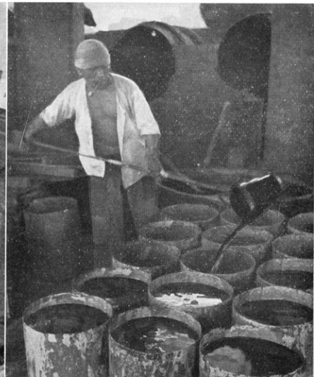
溶融硫黄のくみ取り作業
