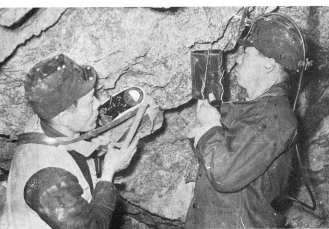
坑内での測定 左の測定器はシンチロメーター Model 963型 右はPW4010 バッテリーモニター
