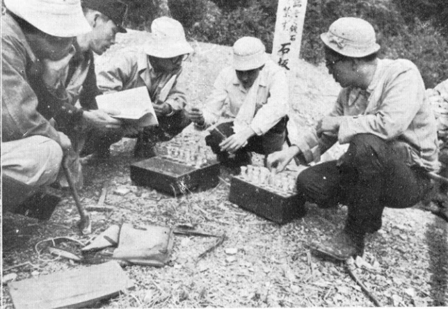
小鴨鉱山では一般に含ウラン鉱石には閃亜鉛鉛が随伴するので常にこれを利用して未知の露頭を探索する場合、亜鉛を対象としてチチソツ試薬で地表水の比色反応をしらべ、露頭露頭の分布を推定する (地化学探鉱)
