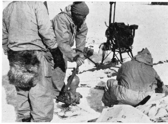
藤井式手押ポンプのテスト (圧力2kg 能力1分間当り40L 重量15kg)
