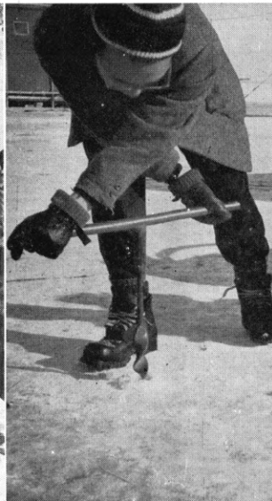
ハンドオーガーで孔を掘る (深度10m 口径4.5cm)
