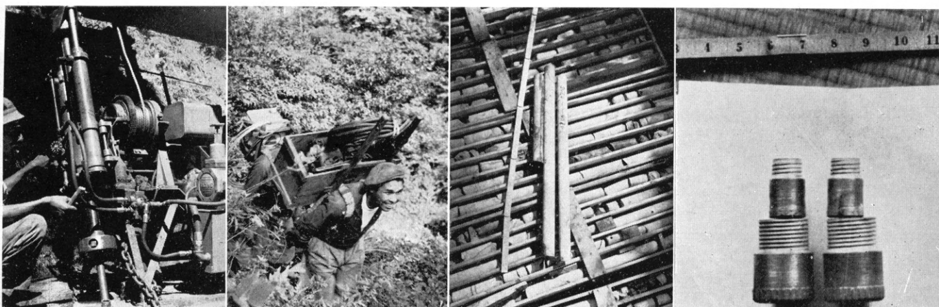
斜に掘進中のBB S-1型試錐機
