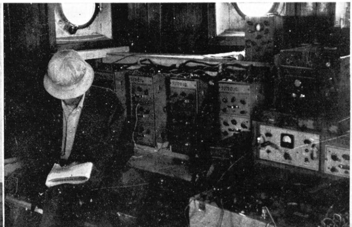
前部の船室へ設置したSSC型地震探査装置 右側が記録器、中央から左が増幅器
