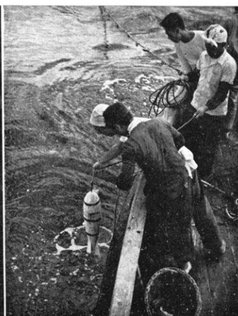
ブーンは舷側に触れないよう うに注意して投下される
