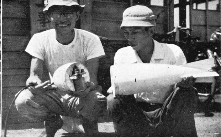
ブーンの中には耐水装置を した受振器が入れてある
