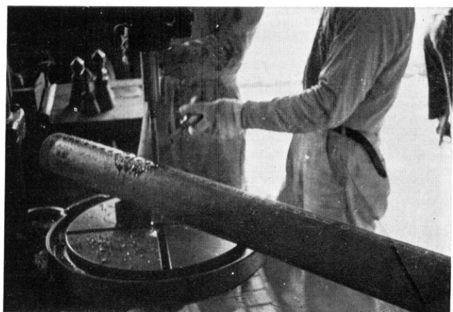
ストレーナの スロット製作中
