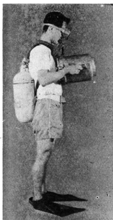
潜水器の装着 (手に持つはカメラを入 れる防水ケース)
