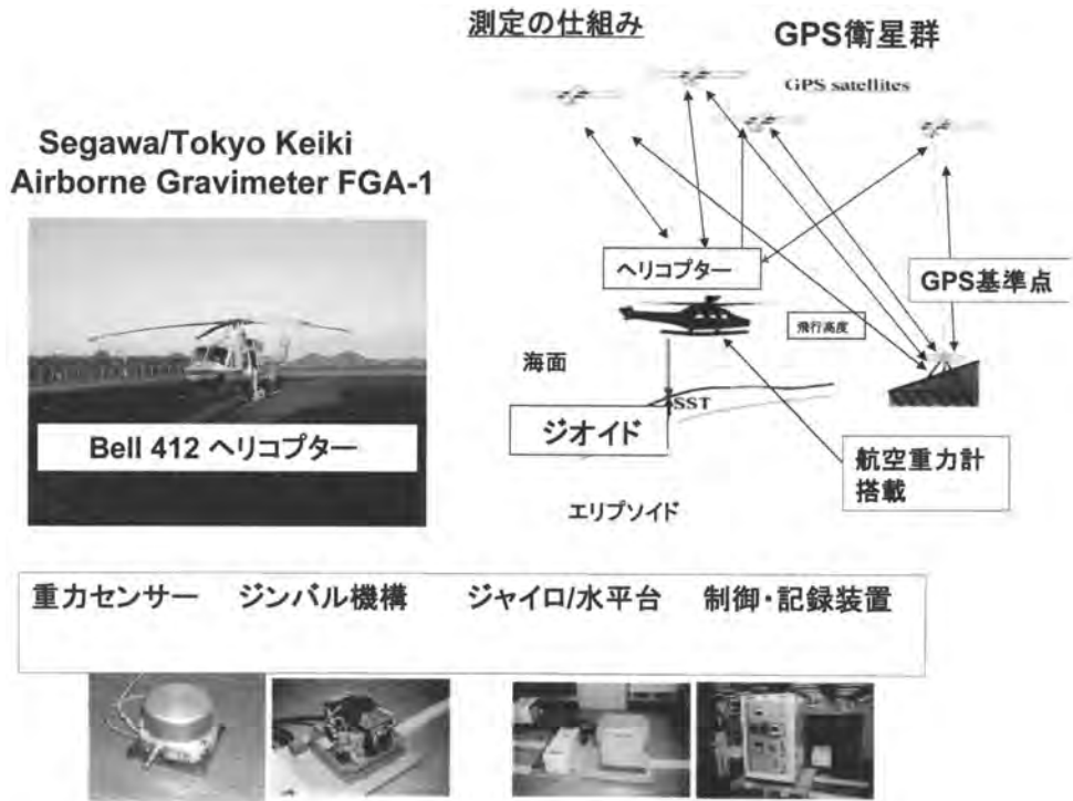
第1図 国産空中重力計の構成と重力測定の仕組み。
