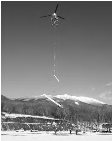
第2図 2000年11月の岩手火山地域空中電磁・磁気探査の際、使用した探査ヘリコプター(東邦航空(株)所有)。機体下部に、磁気バード(上方)と電磁バード(下方)を曳航して、地磁気の強さと見掛比抵抗を測定します(撮影:2000年11月)。
