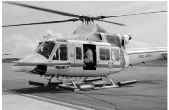
第7図 2008年10月の能登半島北部沿岸域重力探査に使用した探査ヘリコプター(朝日航洋(株)所有；撮影2008年10月)。機体内部に空中重力計、光ファイバージャイロ、GPS受信機及びデータ収録装置などの測定機器が収納されています。
