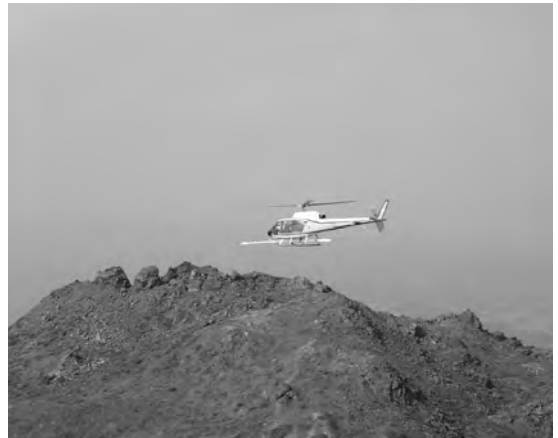
第1図 2000年6月の有珠火山地域高分解能空中磁気探査の際、大有珠付近を飛行中の探査ヘリコプター(中日本航空(株)所有)。機体下部に、磁力計センサーなどを収納したスティンガーが固定されています(撮影:2000年6月)。
