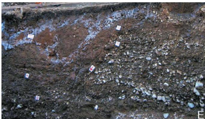
E) 人吉盆地南縁を画す人吉盆地南縁断層のトレンチ調査風景。断層は矢印の位置。同じ記号が同じ扇状地堆積物。2006年2月撮影（錦町別府，宮の谷）。
