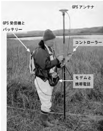
第3図 根室市南部沿湿原において使用した Leica SR530.
