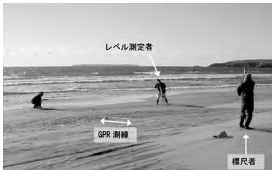
第5図 根室市友知海岸におけるレベル測量の作業風景。人員は最低2名必要。風の強い海岸では、標尺を地表面に対して垂直に保つことは難しいし、風で揺れる標尺の数値をレベルで読み取る作業にも経験がいることも重要。
