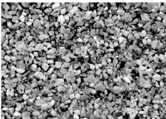
写真5 太平山の砂丘砂。分級良好な中～粗粒砂でした。(画面の上下が約1cm)。
