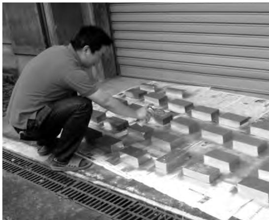
写真1 カラースプレーを用いて重錘用の鉛ブロックに塗装をする様子。
