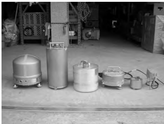
写真1 様々な地震計。左の2つは広帯域地震計 (Streckeisen社製のSTS2とGURALP社製のCMG-3T) で、120秒から数10Hzの地面の揺れまで記録できる。その他の4つは高感度地震計で、右からMark Products社製のL-28B (4.5Hz計)、Lennartz社製のLE-3Dlite (1Hz計)、Mark Products社製のL-22E (2Hz計)、LAC-3D (1Hz計) である。ここで、4.5Hz計とは4.5Hz (約0.2秒) よりも小刻みな地面の揺れを正確に記録できることを意味する。
