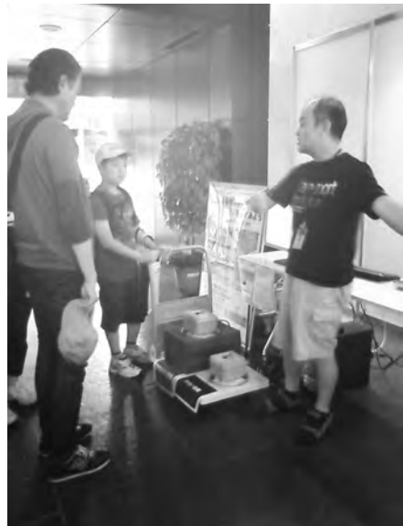
写真4 地盤による地震の揺れ方の体験(台車を用いた実験)の様子。台車の手前側は、台車に直接設置した地震計。後ろ側は、スポンジ(黒っぽい塊)上に設置した地震計。使用した地震計はミットヨ社製の強震計(JEP-6A3)である。
