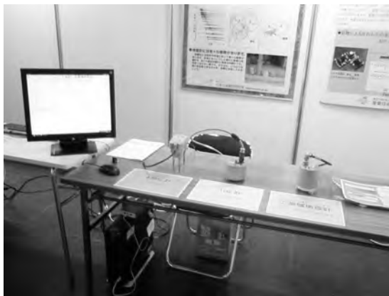
写真2 2つの高感度地震計(左: Mark Products社製のL-28B, 中央: Lennartz社製のLE-3Dlite)と広帯域地震計(右: Nanometrics社製のTrillium Compact)を用いた実験の様子。
