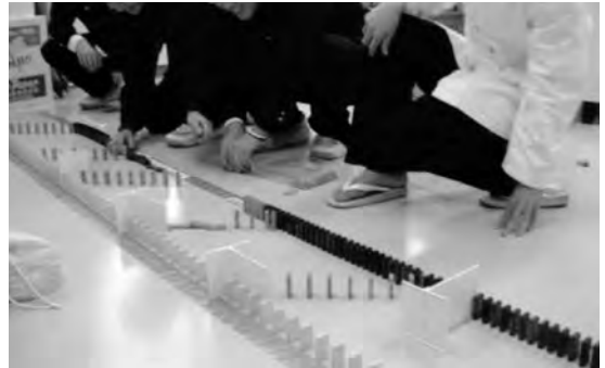
第4図 ドミノを使った走時曲線のモデル実験。
