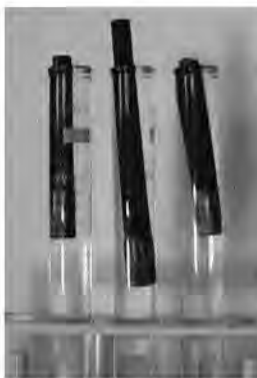
第7図 試験管を用いた鉛筆地殻のアイソスタシー実験。
