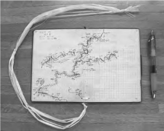
第7図 穴をあけて首かけ用ひもを通した野帳の例。著者が1976年頃に使っていた旧地質調査所製の野帳で、1マスの大きさは5mmである。
