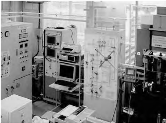
写真2 ガス圧式高温高压変形実験装置。地下深部で起こっている岩石の変形挙動を再現し、断層運動の物理法則を得る。
