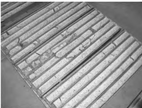
第1図 ボーリング掘削で得られたコア試料(花崗斑岩)の一例。コア試料に認められる亀裂の大部分は断層です。
