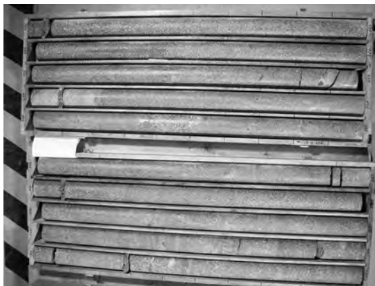
第3図 回収されたコア試料の一部。溶結凝灰岩部分のコア試料(深度480~490m)が写っていますが、亀裂等がほとんどありません。
