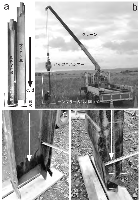
第1図 霧多布湿原でのACEライナーを用いた調査実験の様子。クレーンに吊したバイプロハンマーの打撃によりACEライナーを打ち込む(b)。ACEライナーサンプラー部分の拡大図(a)。サンプラー先端部の拡大図、地中でサンプラーを合体させる為の案内手段(c)、サンプラー側面に取り付けられた三角形の突起物(d)。矢印は挿入方向を示す。
