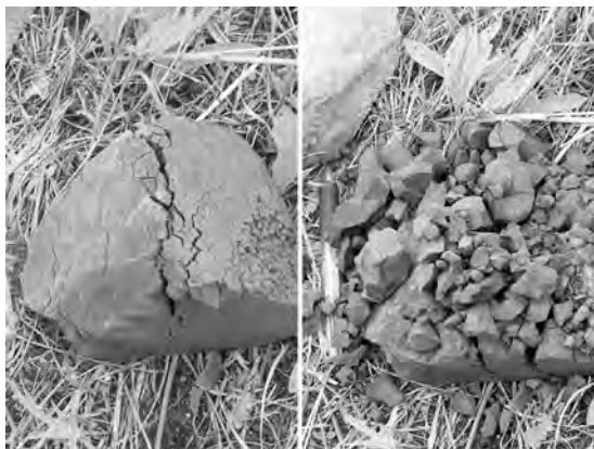
写真22 砕ける礫、ひび割れた礫(左)を持ち上げようとすると細かく割れた(写真22)。
