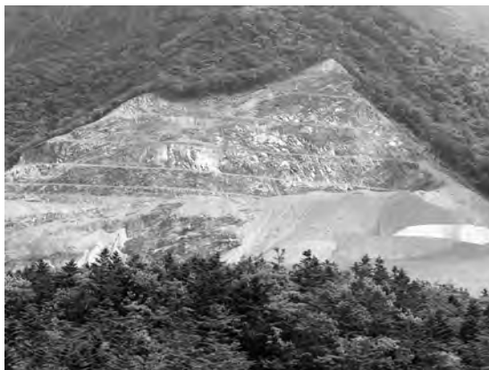
写真28 かんらん岩の採取場。(株)東邦オリビン工業日高事業所。層状の高品位部を採掘する。
