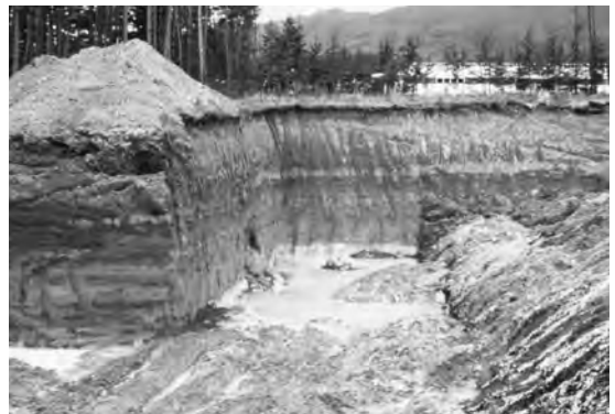
写真3 林地でのカオリンの採掘。傾斜した道路が造られ、鉱石は重機でダンブ・トラックへ積み込まれる。
