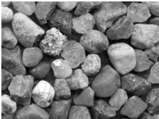
写真39 古第三紀層中の砂礫。採取場の砂の粗粒部を篩い分けた資料である(画面上下が約2cm)。
