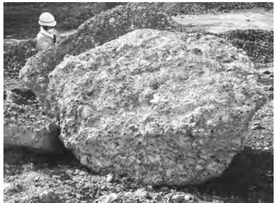
写真38 コンクリートのような塊。カルシウム分で膠着された一種のノジュールである。
