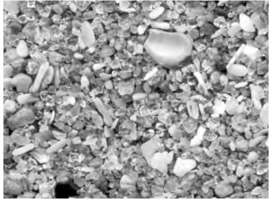
写真7 長浜の砂。白い石英と淡褐色の貝殻片の混合物からなる粗粒砂(画面上下が約1.4cm)。
