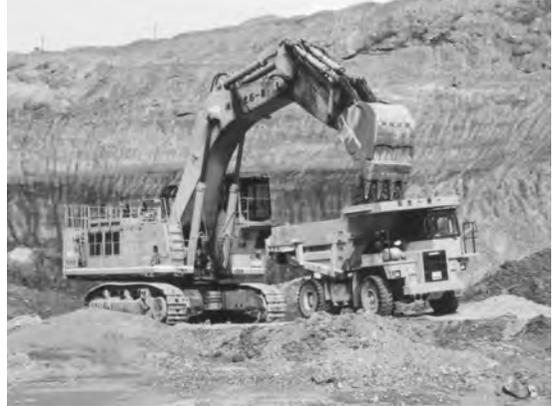
写真37 山砂利の採掘。第一石産運輸(株)の石城事業所での砂利の採掘・積み込み風景。
