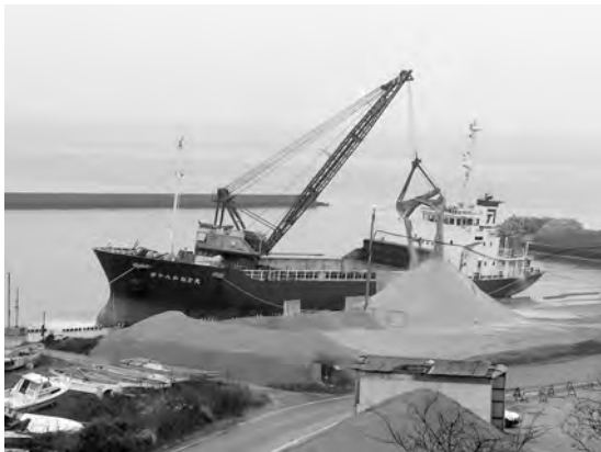
写真15 白野港. 700トンクラスの運搬船が石灰岩碎砂を陸揚げ中のような。
